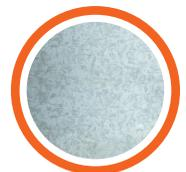
Chapa laminada en caliente o frío revestida en ambas caras con una capa de zinc por el proceso de inmersión en un baño de zinc fundido. Adquiere resistencia a la corrosión.
